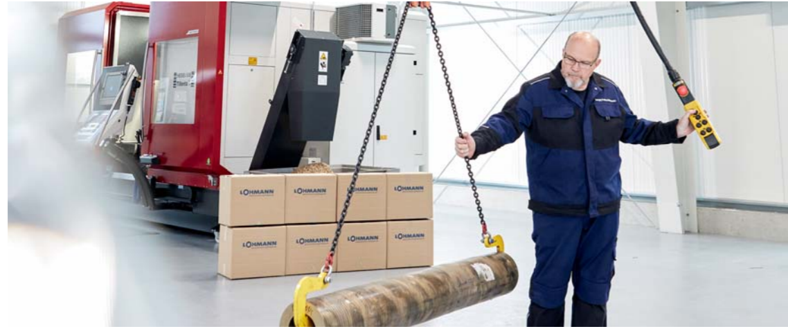
Transport des Rohmaterials zur Fräsmaschine.
