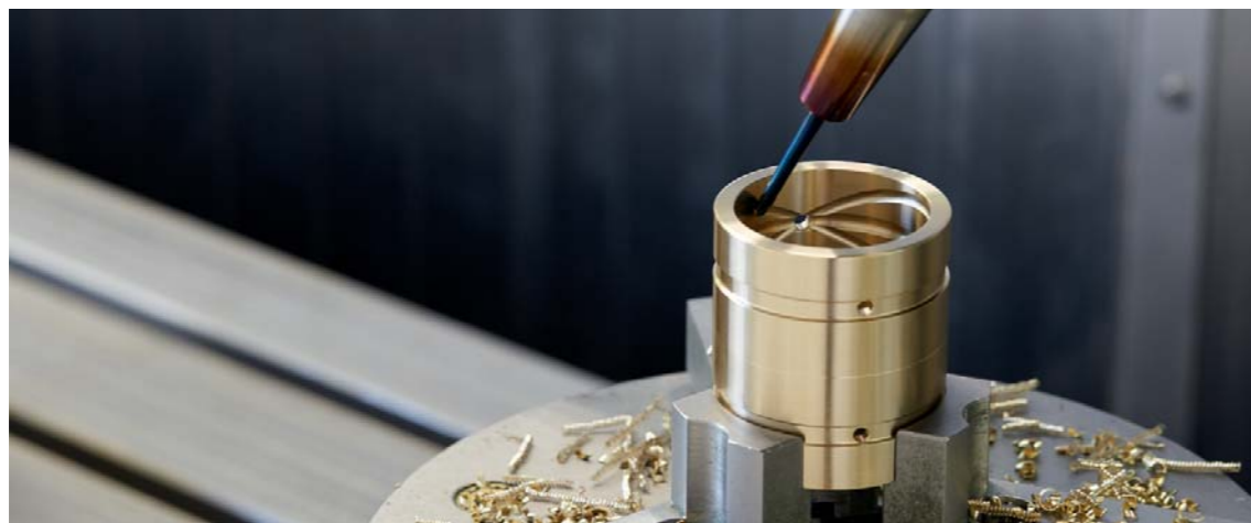
Kundenspezifisches Gleitlager mit Spiralnuten.
