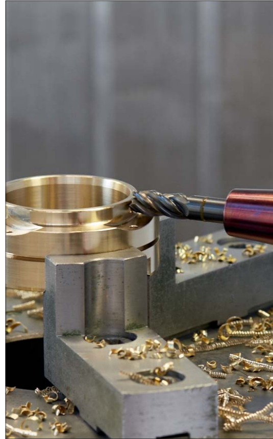
Gedrehtes Gleitlager made by Lohmann
